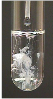
Figura 9 – Formazione del precipitato di cloruro d'argento
