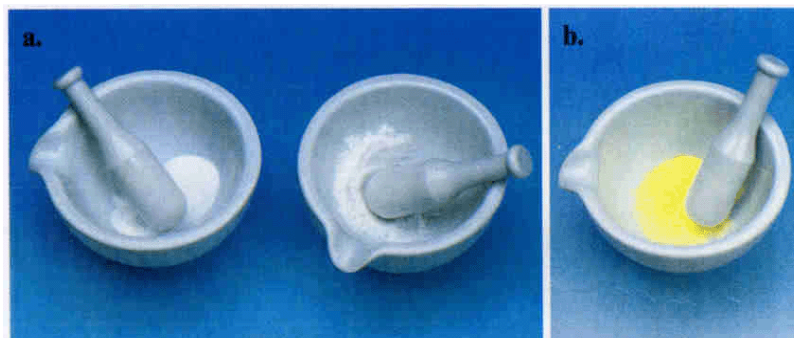
Figura 1 – Il nitrato di piombo e lo ioduro di potassio prima (a) e dopo (b) il mescolamento
